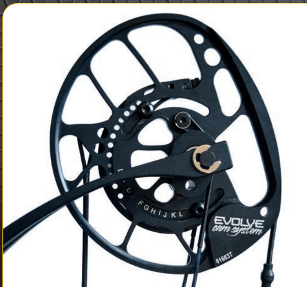
Man kann den Auszug komfortabel ohne Presse in 0,5" Schritten verstellen. A steht für 31,5", bis zu L mit 26".
